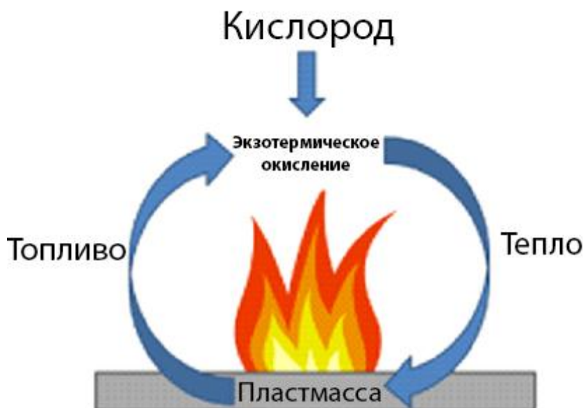
Рисунок 2 – Схематическое изображение материального и энергетического цикла пожара
