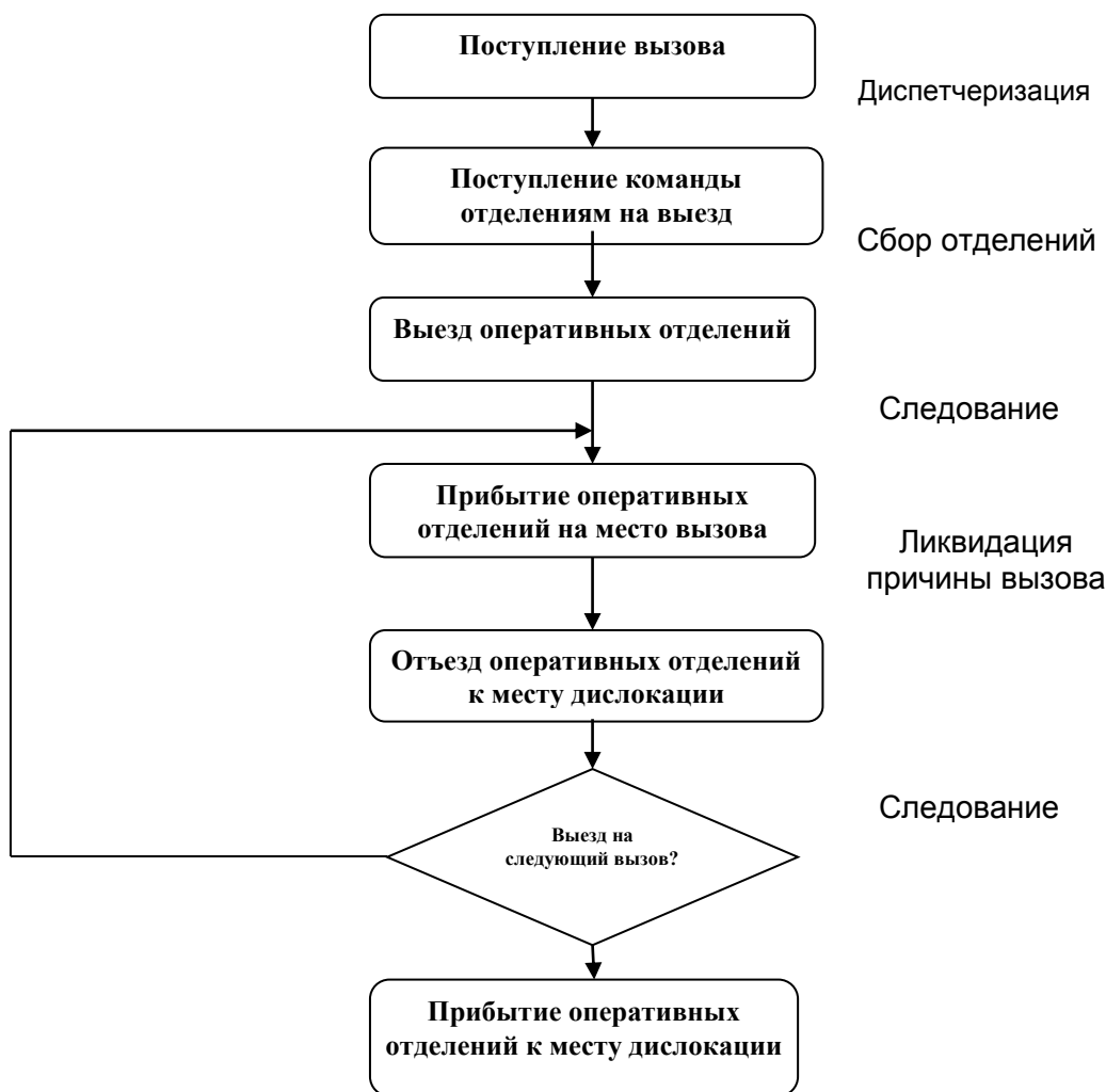
Рисунок 2 – Общий алгоритм функционирования пожарно-спасательных подразделений
