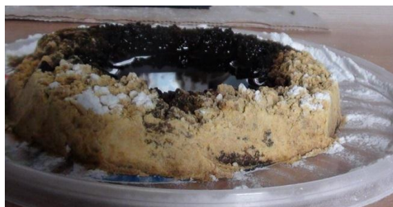
Рисунок 2 – Нефть внутри кольцевой обваловки из ДГСК
