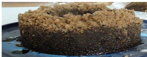
Рисунок 3 – Нефть внутри кольцевой обваловки из песка
