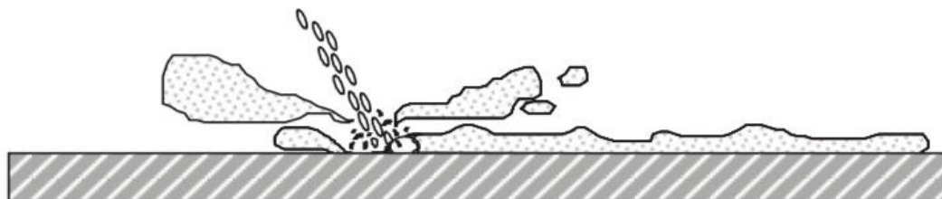
Сурет 2 – \text{CO}_2 кеңеюі және түйіршіктердің кинетикалық энергиясы алынатын жабынның бөлшектерін құлатады және тазалайды
