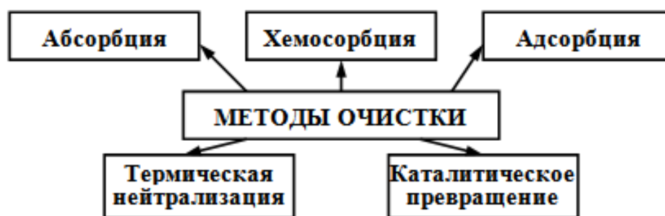
Рисунок 1 – Методы очистки с учетом протекания физико-химических процессов
