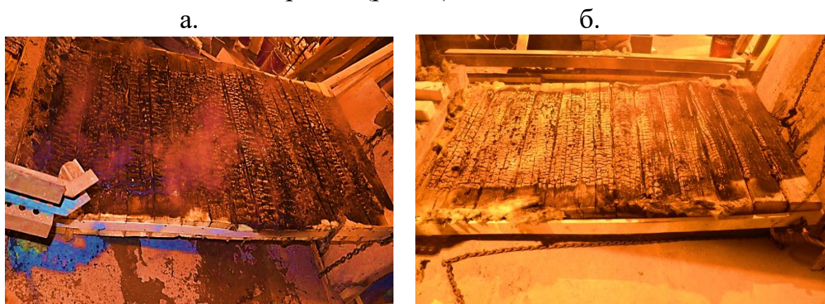
Рисунок 2 – Общий вид ограждающих деревянных конструкций после огневых испытаний по ГОСТ 30403-2012: а – ограждающая деревянная конструкции без естественной выдержки; б – ограждающая деревянная конструкции длительного срока эксплуатации (более 80 лет).
