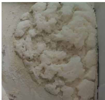
Рисунок 2 - Внешний вид БТП \text{NH}_4\text{Cl} (4,5%) + \text{Na}_2\text{O} \cdot 2,5\text{SiO}_2 (6%) + 6% ПО. + 0,5 % КМЦ через 2 суток экспозиции
