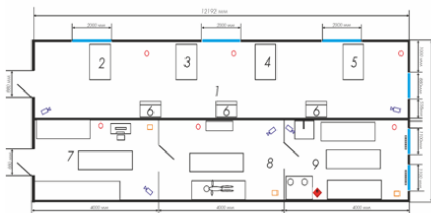
3 Сурет – Жаттығу кешенінің 2 қабат жоспары: 1-жылу камерасы, 2-жүгіру жолағы, 3-велотренажер, 4-тік эргонометр, 5-шексіз саты, 6-степ-тест баспалдағы, 7-жатыс бөлмесі, 8-зал, 9-ас бөлмесі
