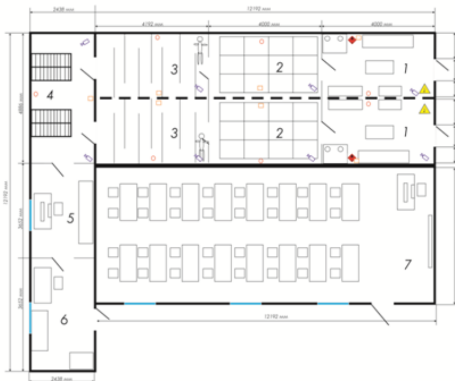
2 Сурет – Жаттығу кешенінің 1 қабат жоспары: 1-өрт модулі, 2-тар жер бөлмесі, 3-лабиринт, 4-саты торы, 5-сабақ жетекшісінің бөлмесі, 6-медициналық бөлім, 7-ГТҚҚ сыныбы
