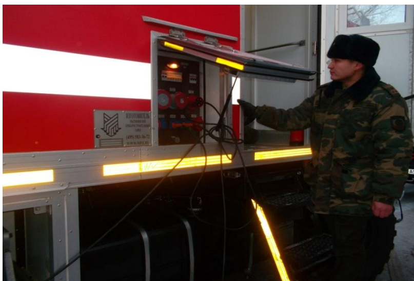
5 сурет – Көп мақсатты өрт сөндіру автомобилінің электр жүйесі
