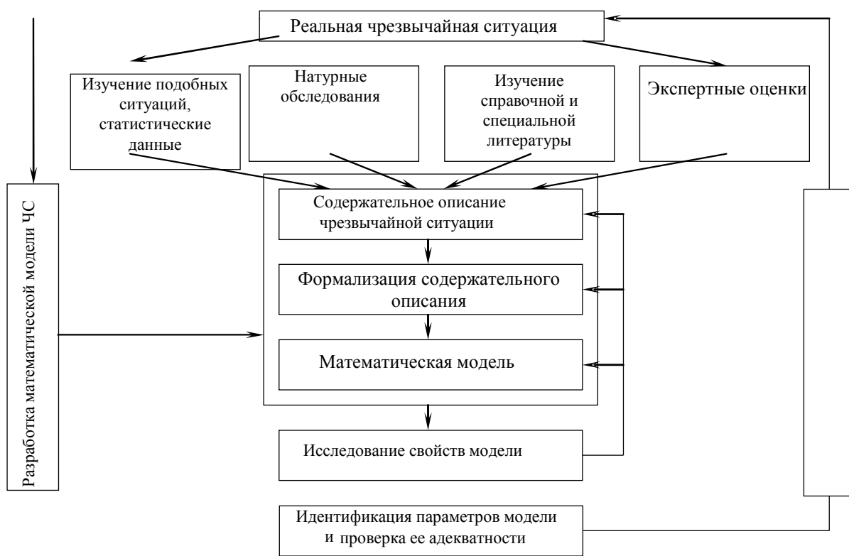
Рисунок 1 - Схема построения математической модели
