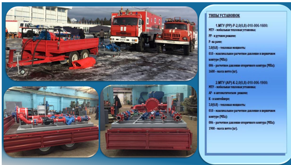
Рисунок 3 – Типы мобильных тепловых установок для совместной работы с АПМ
