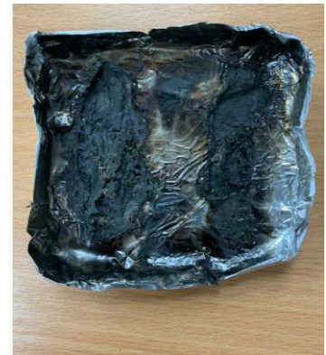
Рисунок 3 – Образцы киноплёнки до и после экспериментов
