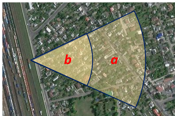
Рисунок 1 – Зона заражения при проливе соляной кислоты m = 0,85 т. v = 5 м/с
