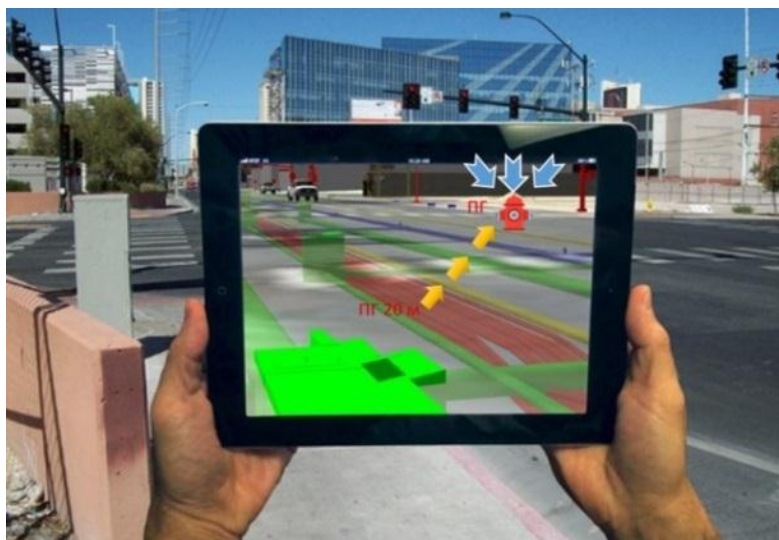
Рисунок 1 – Применение технологий дополненной реальности при поиски пожарного водоисточника на планшете
