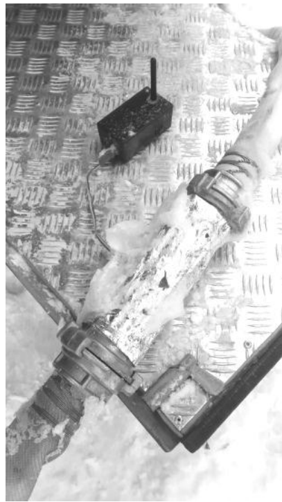
Рисунок 3 – Рукавные вставки с диаметром Ду 50 с температурным датчиком: а – рукавная вставка № 2 с температурным датчиком при выходе из рукавной линии; б – рукавная вставка № 1 с температурным датчиком при входе в рукавную линию
