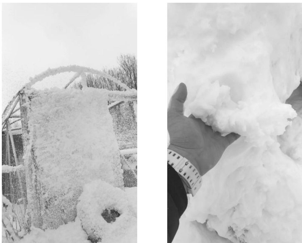
Рисунок 5 - Вид компрессионной пены после подачи
