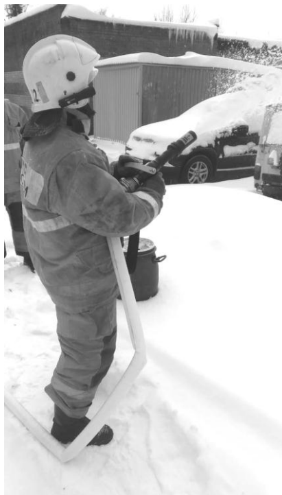
Рисунок 4 - Подача компрессионной пены по рукавной линии
