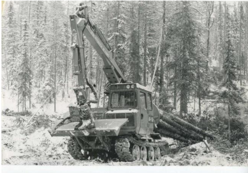
Рисунок 2 - Валочно-транспортная машина ЛП-17А Трелевка деревьев в полупогруженном положении
