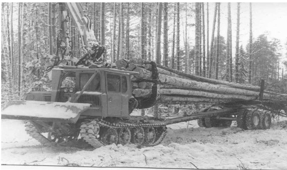
Рисунок 1 - Валочно-трелевочная машина ЛП-17А Транспортирование деревьев в погруженном положении
