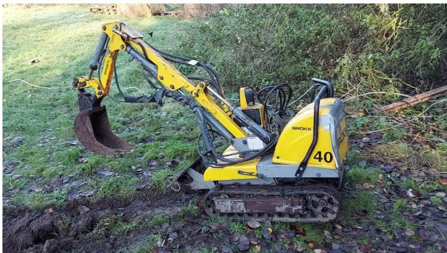
Рисунок 4 - Электрогидравлическое робототехническое средство «BROKK-40»
