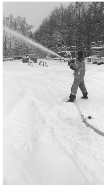
Рисунок 4 - Подача компрессионной пены по рукавной линии
