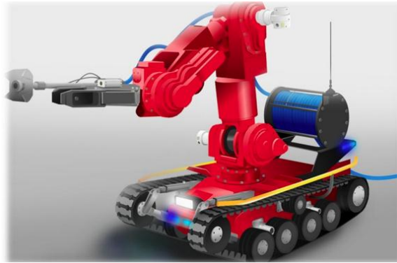
Рисунок 2 - Робототехническое средство, оснащенное роботизированной рукой-манипулятором со схватом, имеющая пять степеней свободы, ствол установки пожаротушения с гидроабразивной резкой, предназначенный для тушения пожаров и резки конструкций, система технического зрения, тепловизор и набор необходимого оборудования
