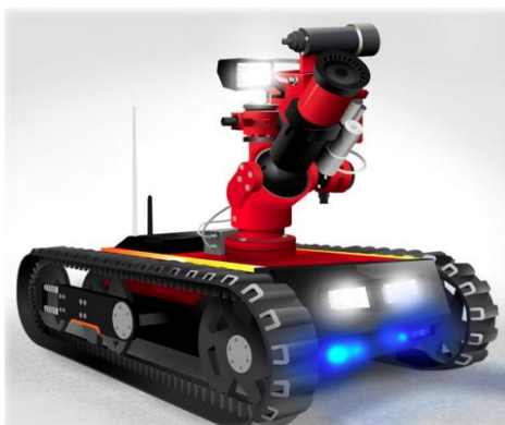
Рисунок 1 - Робототехническое средство предназначено для разведки на месте пожара, мониторинга обстановки и выполнения действий по тушению пожаров.
