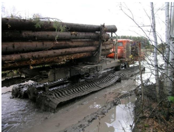
Рисунок 6 - Транспортно-технологическая машина повышенной проходимости с полуприцепом на шасси завода ООО «ЕЗСМ «Континент» при транспортировании пачки деревьев в полностью погруженном положении в сложных природно-климатических условиях
