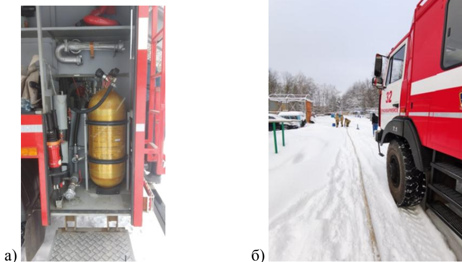
Рисунок 1 - Пожарная автоцистерна АЦ 3,0-40 NATISK с установкой подачи компрессионной пены:
