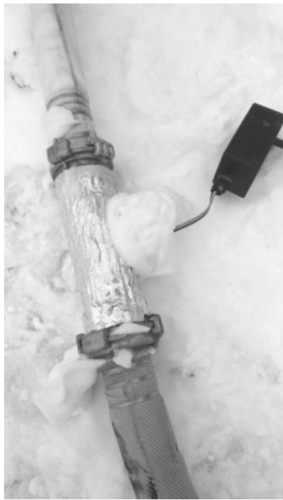
Рисунок 3 – Рукавные вставки с диаметром Ду 50 с температурным датчиком: а – рукавная вставка № 2 с температурным датчиком при выходе из рукавной линии; б – рукавная вставка № 1 с температурным датчиком при входе в рукавную линию
